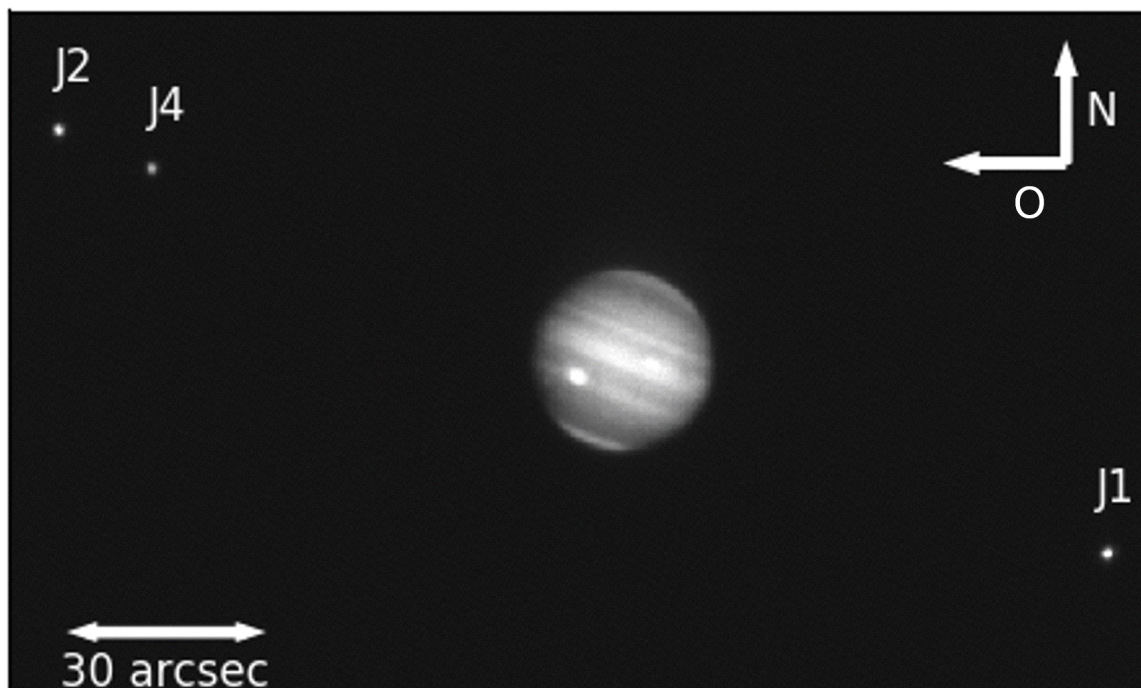
Figura 6 – Imagem de Júpiter, Io (J1), Europa (J2) e Calisto (J4) obtida no telescópio Zeiss de 60 cm de abertura do Observatório Pico dos Dias (OPD), equipado com o filtro Metano de banda estreita. Imagem obtida em 19 de novembro de 2014. Note que o planeta e os satélites apresentam o brilho similar devido ao uso deste filtro.
