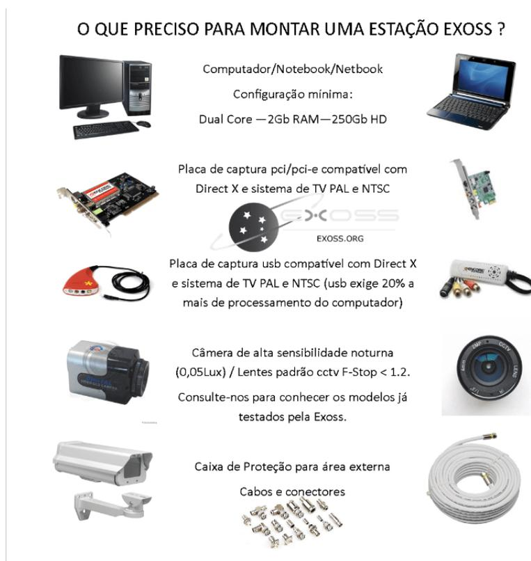
Figure 2.9: *Folder descritivo do conjunto de equipamentos utilizados para montar uma estação de monitoramento de meteoros da EXOSS.*
