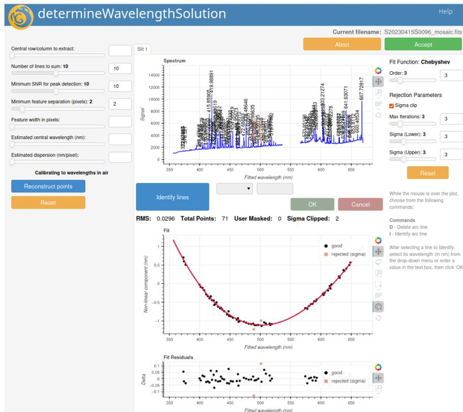
Figura 3.10: Tela interativa do Dragons com o ajuste da solução em comprimento de onda da lâmpada.
