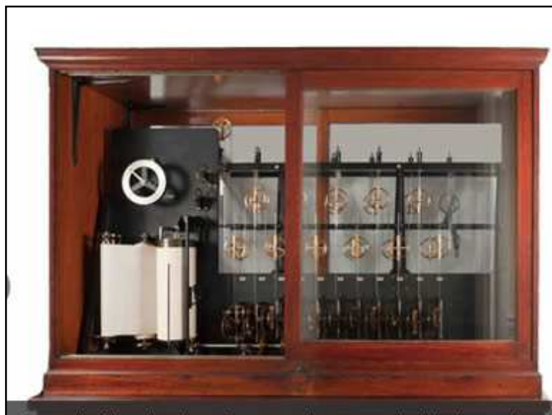
Figura 2-4 - Foto da máquina de previsão mecânica, fabricante: Kelvin Bottomley & Baird – Fonte: http://www.mast.br/bases/sgm_consulta/telas/consulta/detalhe_consulta.asp?ID=1994/0356a&nome_obj=Previsor%20de%20Mar%E9s
