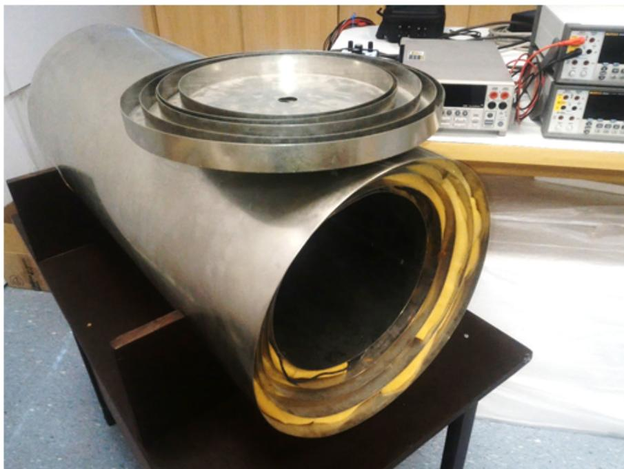
Figura 5.4: Imagem da blindagem magnética utilizada para caracterização em campo magnético aproximadamente nulo.
