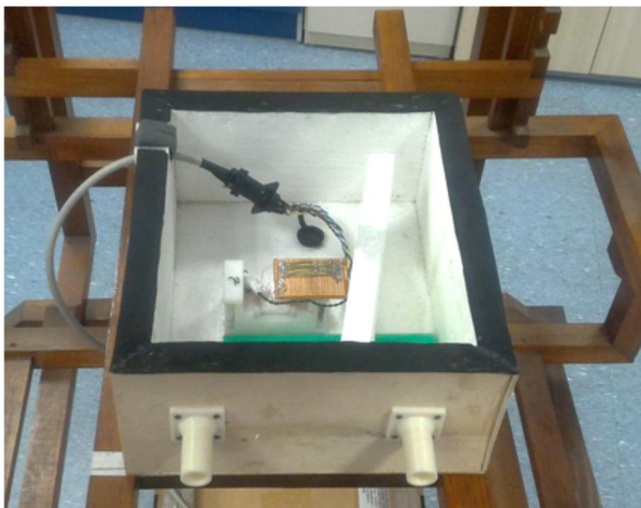
Figura 6.4: Imagem da blindagem térmica utilizada para caracterização em campo magnético variável com determinação da dependência térmica.
