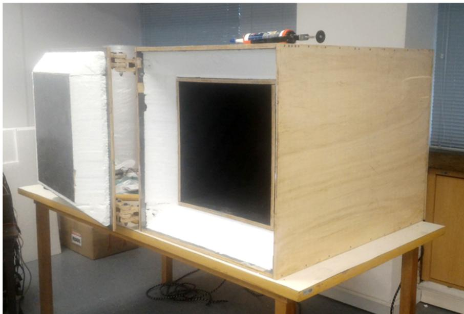
Figura 6.3: Imagem da blindagem termo-magnética utilizada para caracterização em campo magnético aproximadamente nulo com determinação da dependência térmica.
