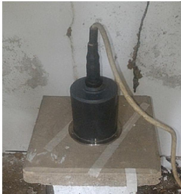
Figura 7.29: Magnetômetro LEMI-417.
