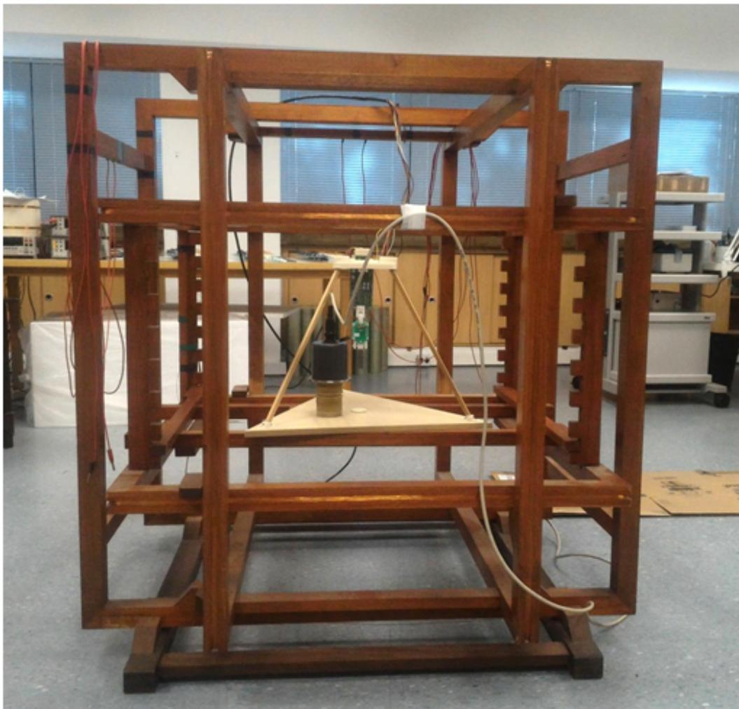
Figura 5.1: Imagem do arranjo triaxial de bobinas de Helmholtz utilizadas neste projeto.
