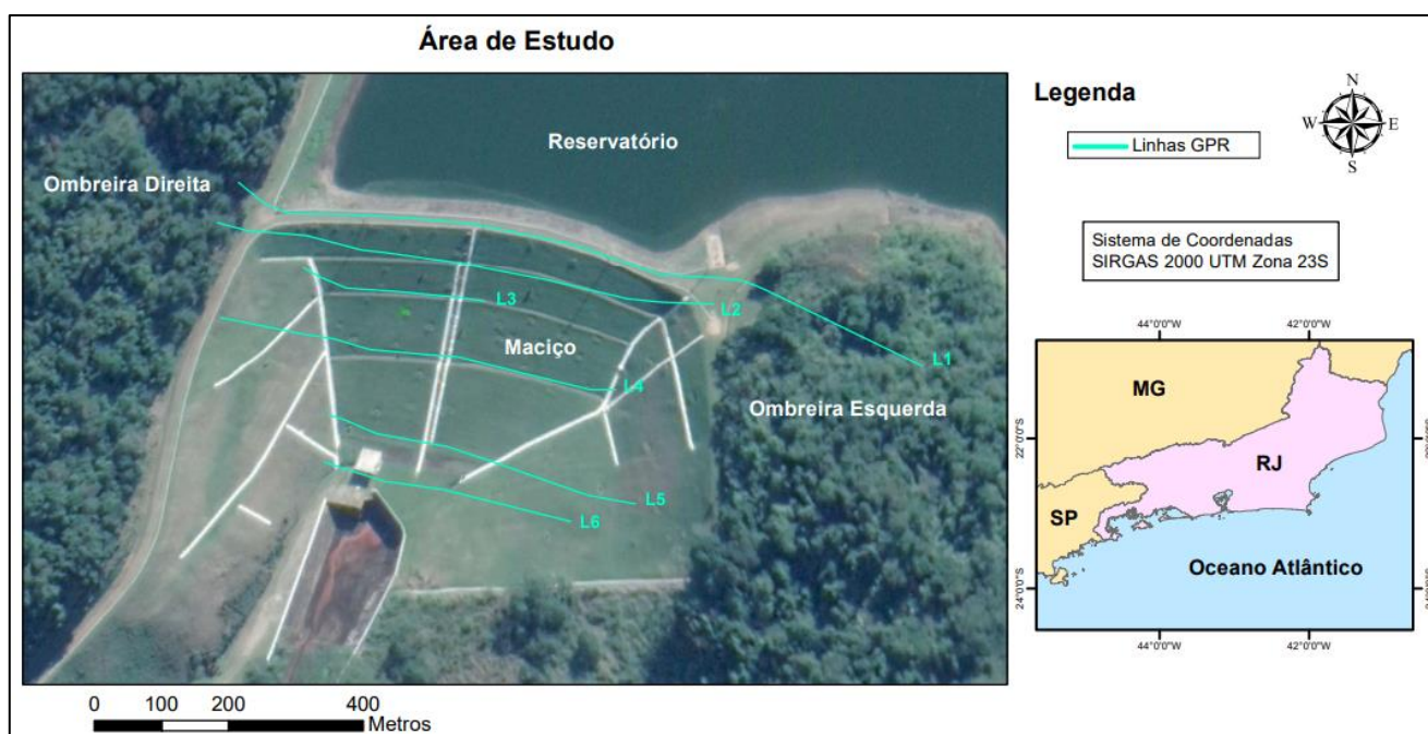
Figura 7.18. Mapa da barragem, exibindo seus principais compartimentos (ombreiras, maciço e reservatório), além do posicionamento das linhas de GPR, em azul.
