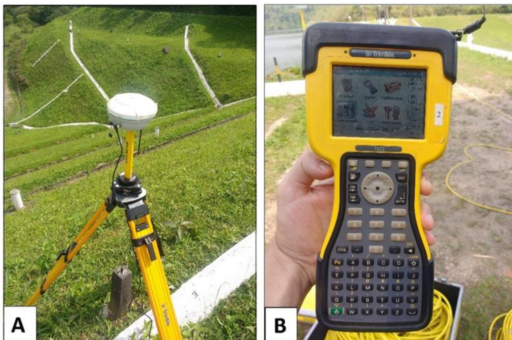
Figura 5.6. (a) Estação base GNSS instalada em posição central na crista da barragem, (b) Controle digital portátil TSC2, ferramenta útil no controle e armazenamento de dados de satélite coletados por meio das estações móveis.
