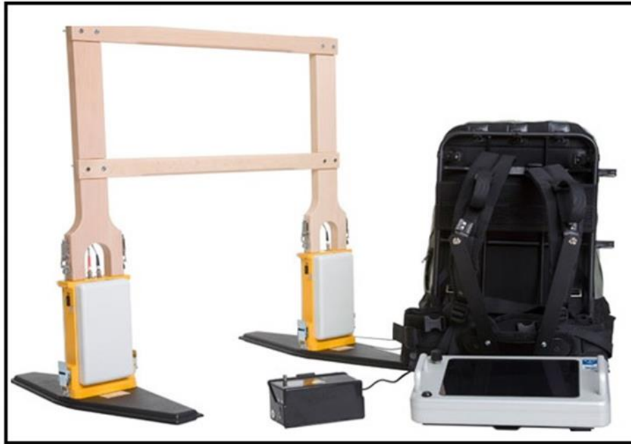
Figura 5.5. GPR ProEx System, da marca Mala, utilizado na primeira campanha de aquisições geofísicas. O suporte de madeira serve para espaçar as antenas no método common offset . O monitor digital é transportado em uma unidade portátil, junto a bateria externa.
