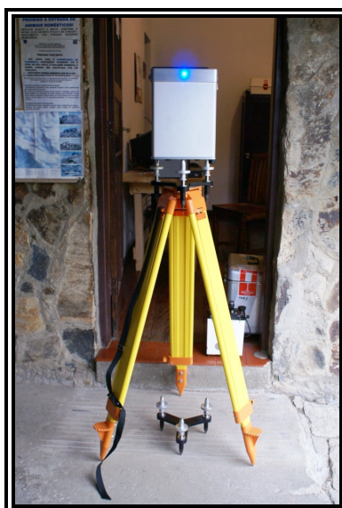
Figura 2. Tripé geodésico (em amarelo) em conjunto com os tripés dos gravímetros Scintrex CG-5 (preto).
