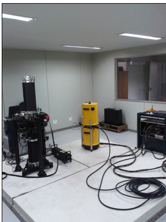
Figura 3-2. Sugestão de comparação dos padrões absolutos de gravidade A-10 #011 e FG-5 #223 sobre os pilares do LabGrav/ON em Vassouras – RJ.
