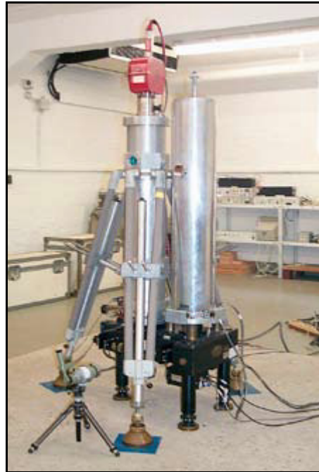
Figura 2-2. Gravímetro absoluto JILAg-3 do Institut für Erdmessung (IfE) utilizado em campanhas de gravimetria absoluta em vários países (Timmen et al. , 2008).
