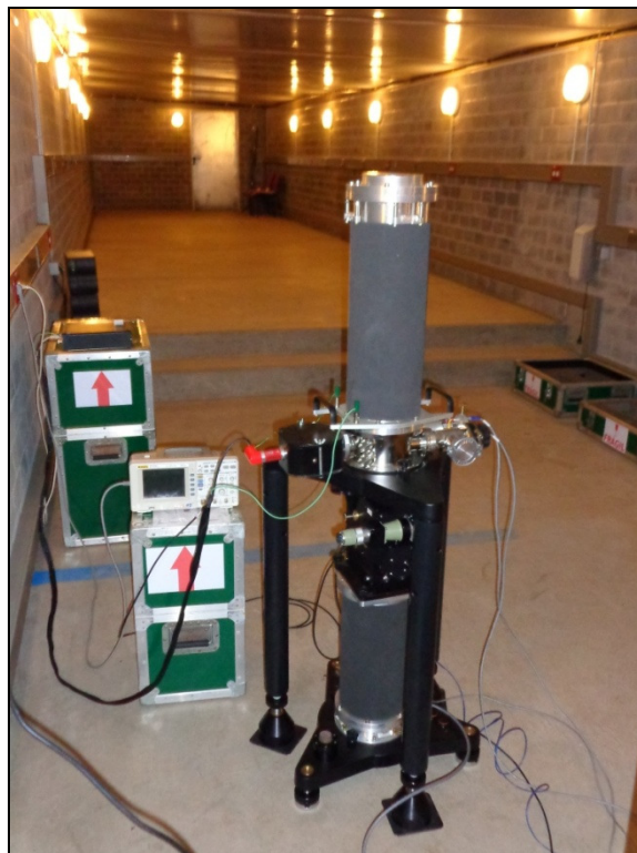
Figura 5-2. Gravímetro FG-5 #223 sobre o pilar B4 do Walferdange Laboratory Underground for Geodynamics em Luxemburgo durante a ICAG-2013.
