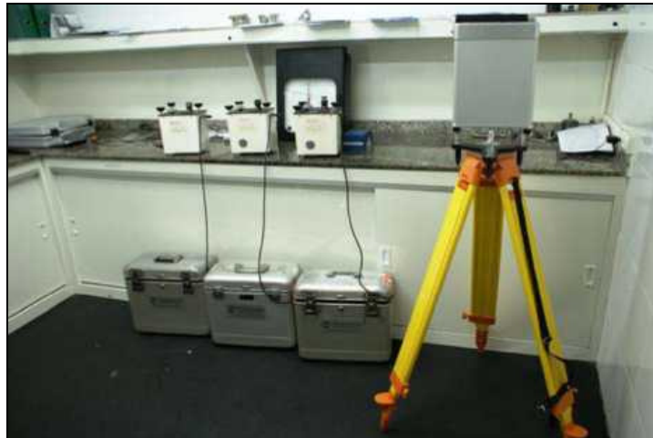
Figura 3-3. Metodologia adotada na determinação do GVG utilizando ambas as técnicas: piso-bancada e piso-tripé.
