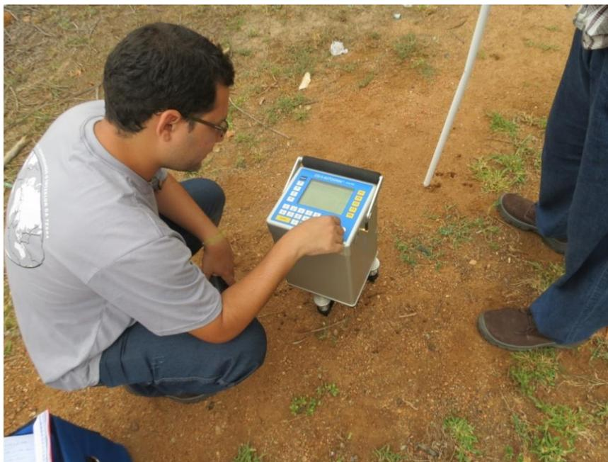
**Figura 16.** Aquisição de medidas utilizando o gravímetro CG-5 Scintrex.
