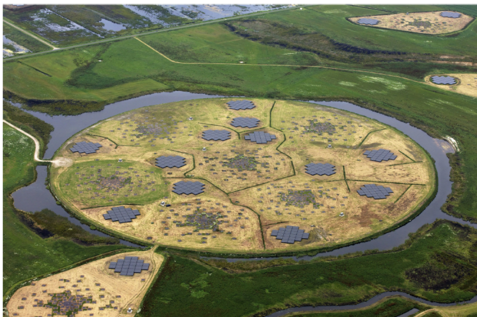
Figura 2.2: Núcleo do LOFAR (Superterp) nos Países Baixos, mostrando a concentração densa de antenas que proporciona alta sensibilidade para emissão extensa. Disponível em: Netherlands Institute for Radio Astronomy .
