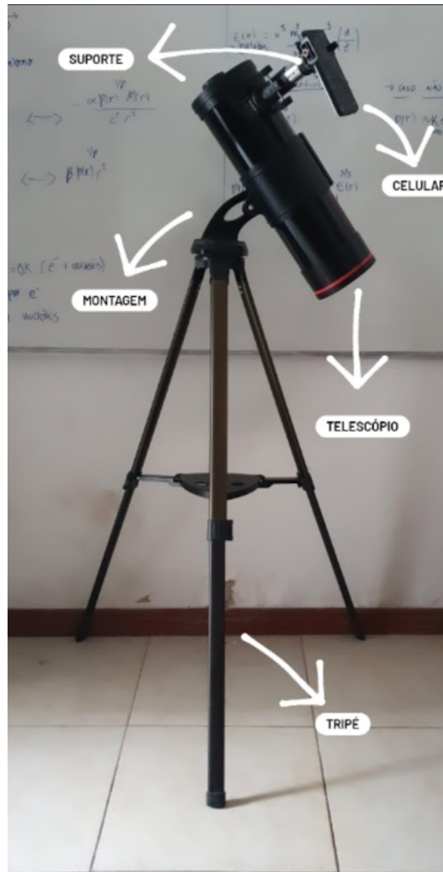
Figura 2.4: Telescópio Newtoniano amador modelo Tasco, com 114 mm de abertura e razão focal f/4 , pertencente à autora.
