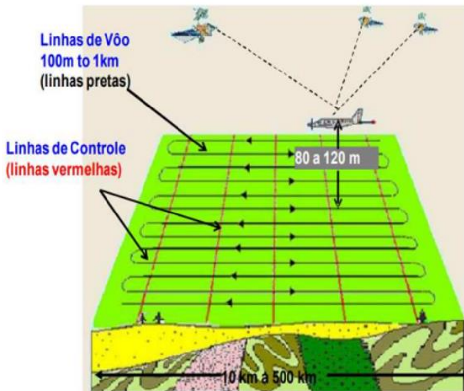
Figura 19 – Exemplo de um plano de voo para um aerolevantamento.
