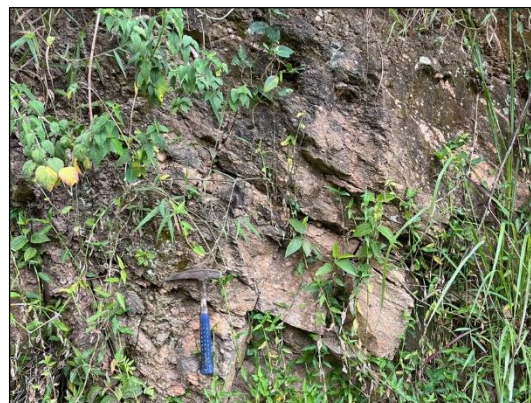
Figura 36 – Detalhe das fraturas métricas observadas no afloramento (34/55;46/51). UTM 23k E: 711163/S: 7547260. Fonte: O autor.
