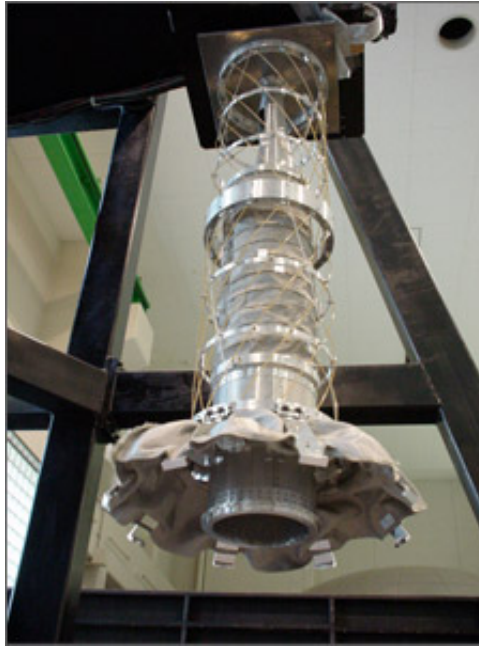
Figura 2.8: Modelo protótipo do tubo coletor presente na Hayabusa I. (Imagem publicada no site da JAXA)
