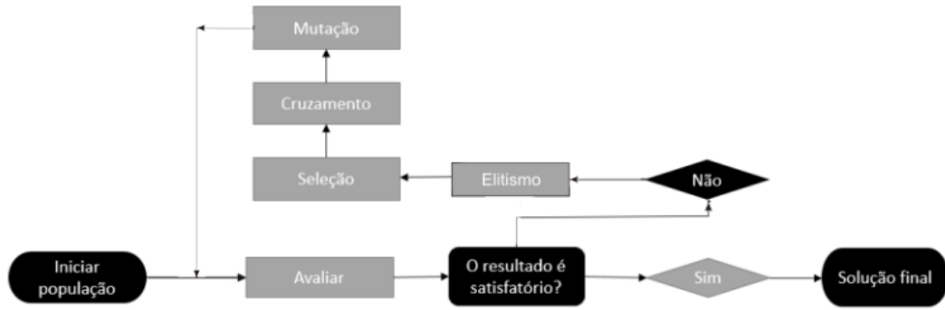
Figura 3.18: Fluxograma simplificado do algoritmo genético, (FARIAS; NETO, 2019).
