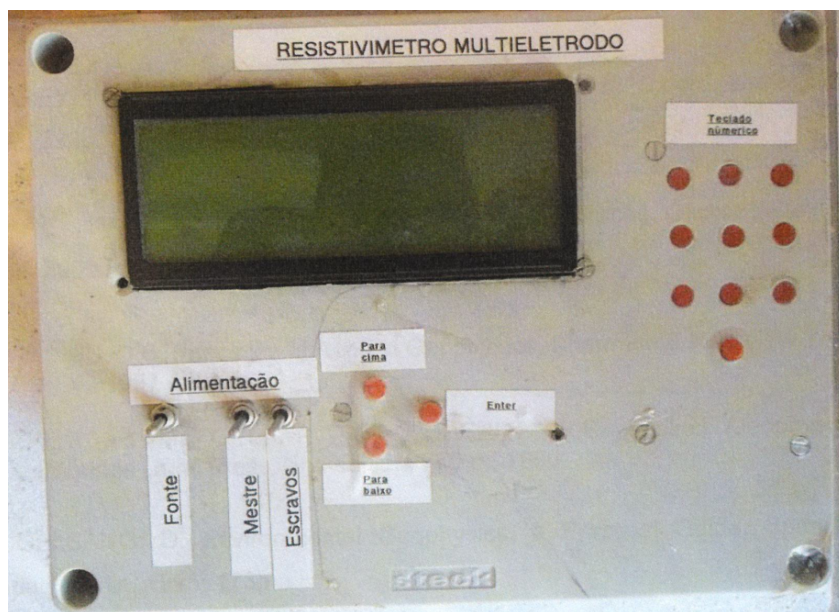
Figura 4.24: Painel frontal do resistivímetro montado em uma caixa light de passagem. Fonte: Adaptado de SANTOS (2014).
