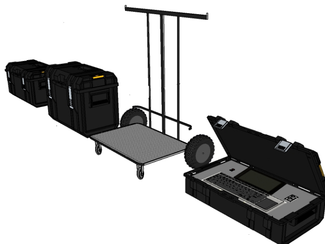
Figura 7.6: O conjunto é formado por três caixa, sendo uma o próprio equipamento, um carrinho metálico com duas rodas e as outras duas para carregar todo material de campo, com uma capacidade de carga de até 40kg e índice de proteção IP65.
