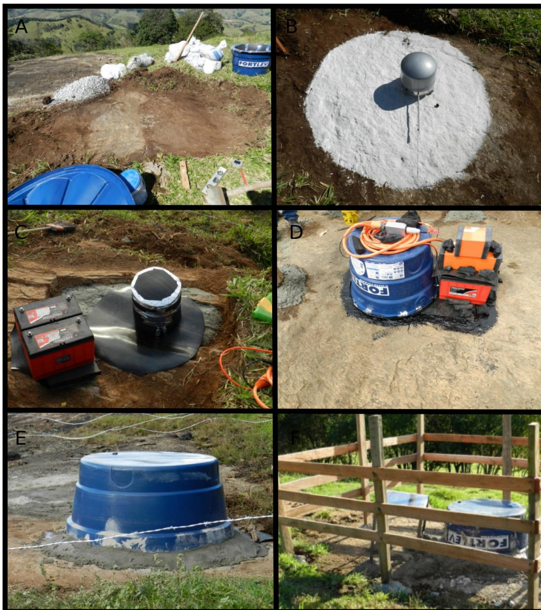
Figura 3.1: Mosaico mostrando como é feita a instalação das estações sismográficas temporárias do projeto SUBSAL. As figuras mostram os diferentes estágios na instalação das estações. A - preparação do terreno para a montagem do sensor. B - nivelamento do terreno. C - isolamento do sensor e acoplamento das baterias. D - isolamento térmico da estação sismográfica. E - proteção da estação sismográfica. F - cerca para evitar o trânsito de animais e pessoas.
