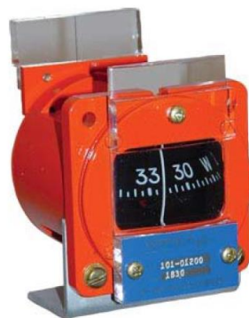
Figura 1.18. Bússola aeronáutica moderna tem precisão de 1°.
