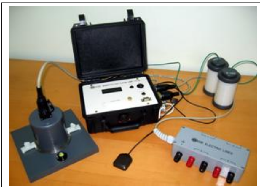
Figura A.1.1: Magnetômetro LEMI-417 ( http://www.isr.lviv.ua/lemi417.htm )
