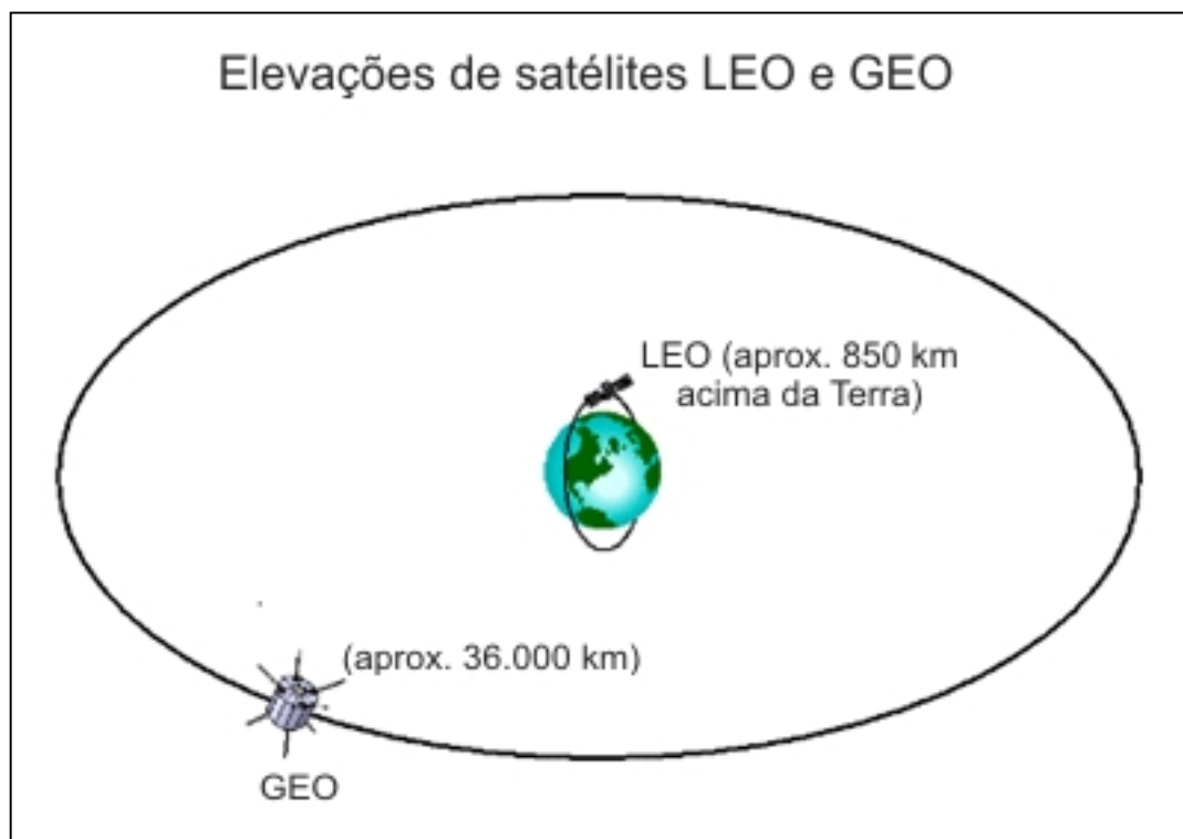
Figura 2.16 - Ilustração para diferenciar satélites LEO dos GEO ( http://mapmaker.meteor.wisc.edu/~jbrunne ).
