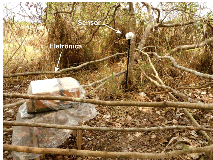
Figura 4.5: Estação instalada no Pantanal para a medição do campo geomagnético total (F).
