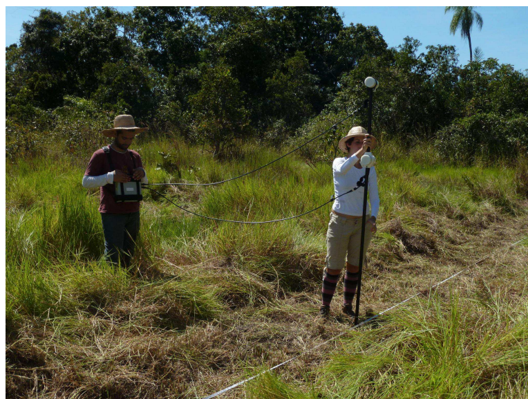
Figura 2.2: Levantamento gradiométrico realizado no dia 19 de maio de 2011 na área escolhida para o OBS-PNL. A foto mostra o gradiômetro utilizado (overhauser GSM-19)
