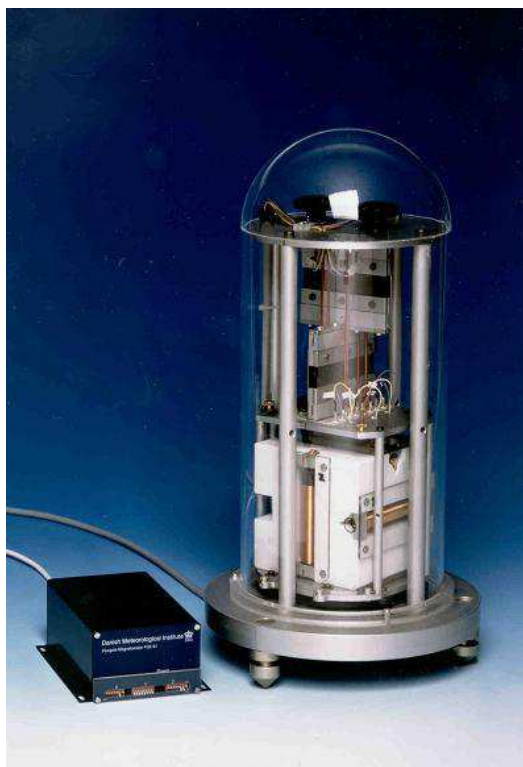
Figura 3.1: Magnetômetro fluxgate triaxial (X, Y e Z) que será instalado no novo observatório magnético do Pantanal.
