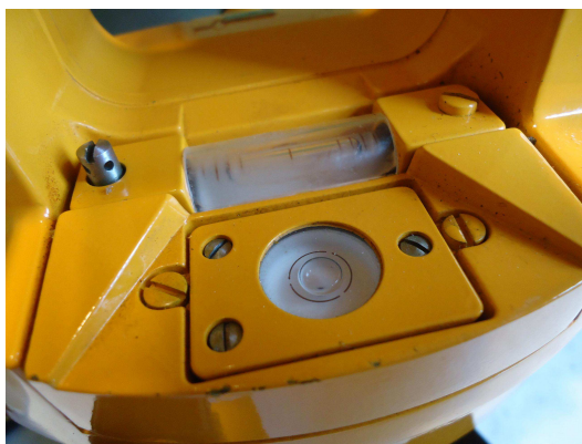
Figura A.4: Níveis de bolha centralizados após o nivelamento com o ajuste dos pés do teodolito.
