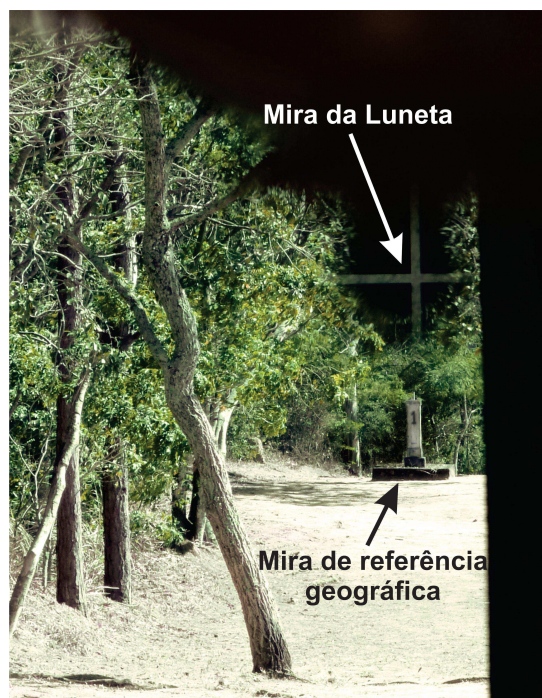
Figura A.9: Ajuste aproximado da mira da luneta na direção da mira de referenciamento geográfico.
