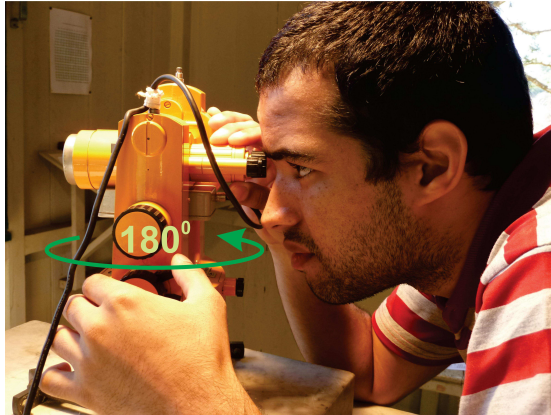
Figura A.21: Girando o Teodolito de 180^\circ no plano horizontal.
