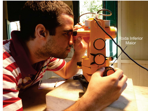
(b) O ajuste fino é feito com as rodas inferiores menor e maior.
