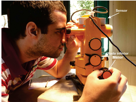
(a) No primeiro momento o sensor deve estar na parte superior.
