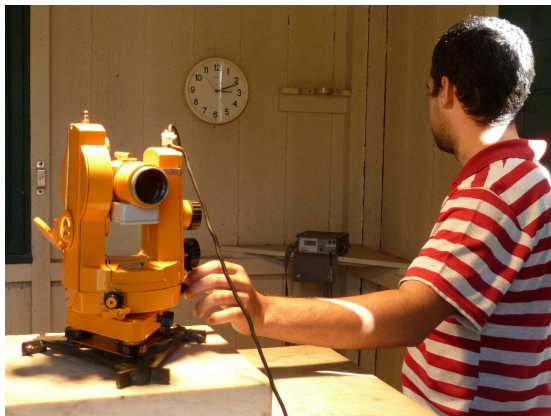
Figura A.22: Girando a roda inferior menor para zerar a eletrônica.
