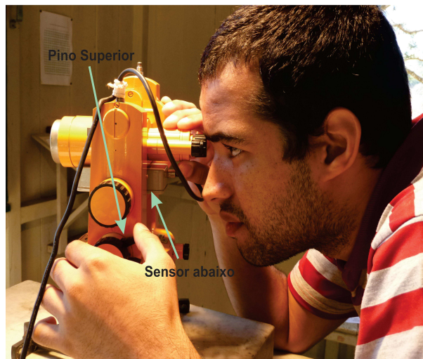
Figura A.18: Posição do sensor e do pino superior na segunda etapa da medição de D.
